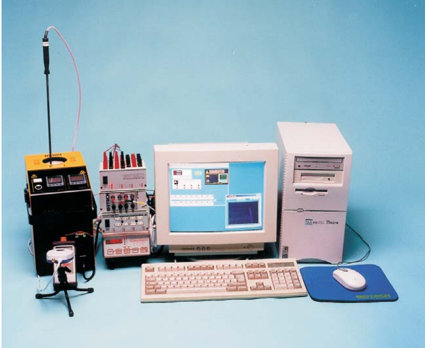
Foto von I-Cal zusammen benutzt mit einem Gemini 700 Metallblockkalibrator und einem PC.
